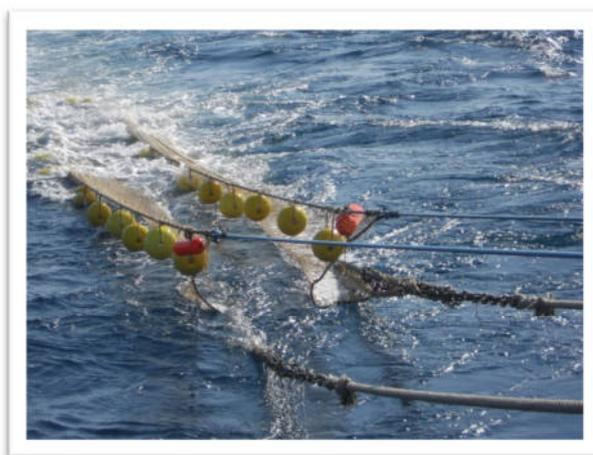
Figura 4 - rete a strascico a divergenti. Particolare della lima dei sugheri e della lima dei piombi (Fonte: COISPA).
